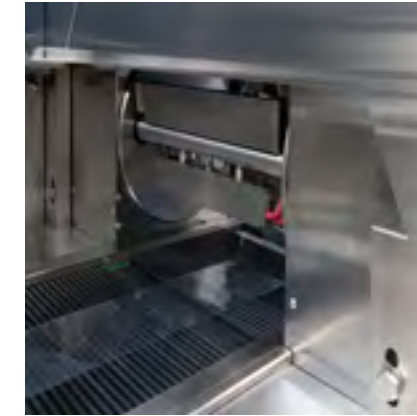
Transversal sealing and out system (QS) Quersiegelung mit integriertem Auslaufband
