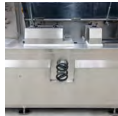
Longitudinal sealing and cut system (LS) Längssiegelung und Randbeschneidung
